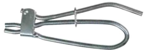
**BRAKE/FUEL LINE CRIMPING PLIERS**
