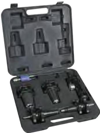
**COOLING SYSTEM PRESSURE TESTER**
